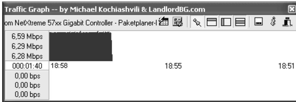
Abb. 43: Auslastung des Ethernets von ca. 6,3 Mbit/s bei einem Paketabstand von 135  $\mu$ s
