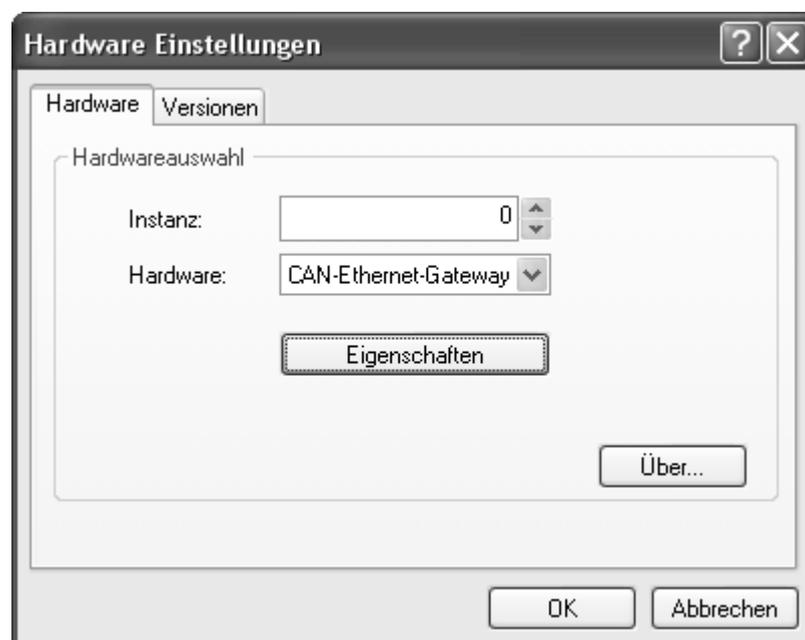
Abb. 18: Fenster für die Hardwareeinstellungen in der Software CAN-REPORT
