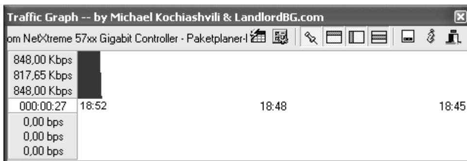
Abb. 42: Auslastung des Ethernets von 848 kbit/s bei einem Paketabstand von 1000  $\mu$ s
