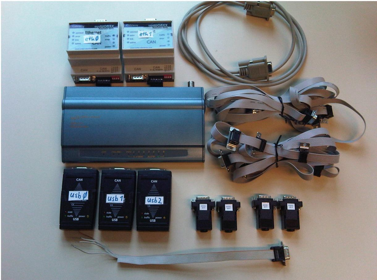
Abb. 10: Fotografie der wichtigsten Komponenten: Ethernet-Gateways, Nullmodemkabel, Ethernet-Hub, CAN-Bus-Kabel, USB-Gateways, Terminatoren, D-Sub-Stecker
